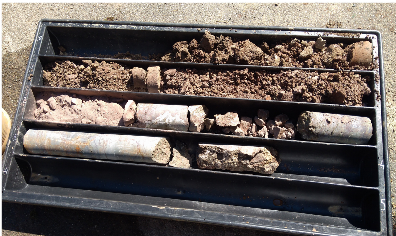
stratigrafia sondaggio S2 da 0 a 3.70 m
