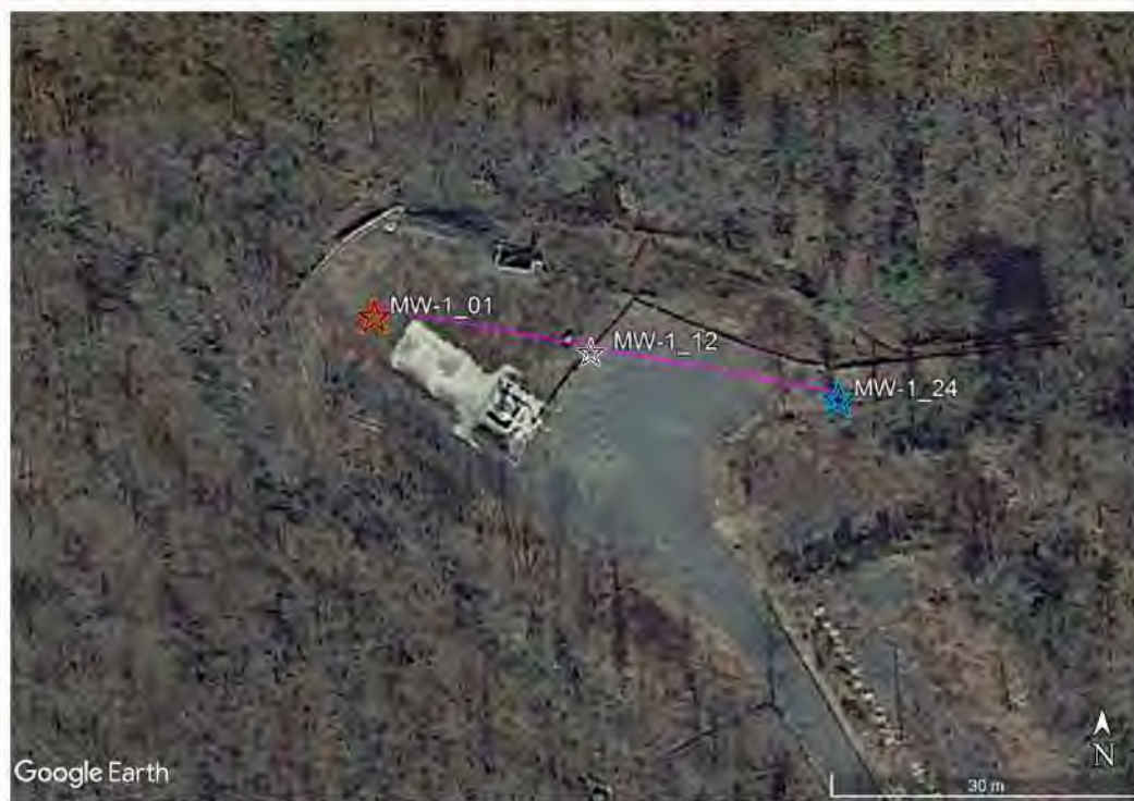
Fig. 5.3 – Postazione pozzo 128. Larderello (PI). Ubicazione dell'indagine MASW (in arancione il punto iniziale, in celeste il punto finale del profilo MASW).
