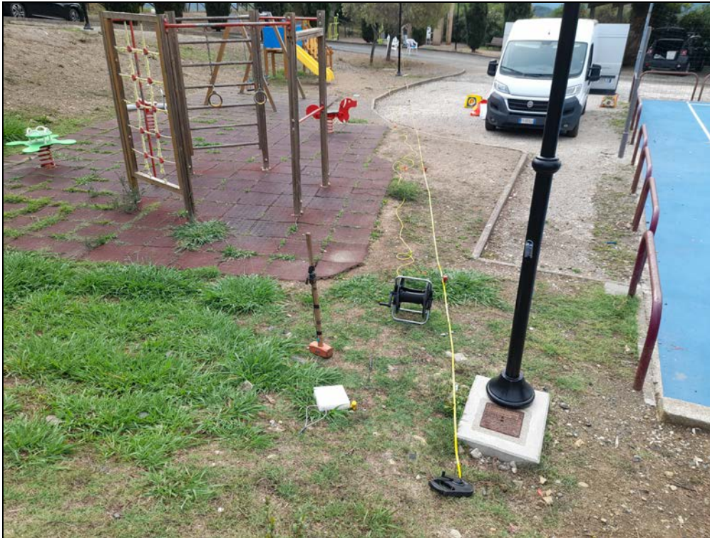
Figura 3. Fase di acquisizione della MASW nella località di interesse eseguita in data 02/09/2022
