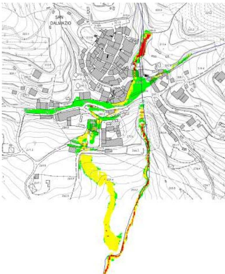
Fig. 29 – Magnitudo idraulica in Loc. San Dalmazio
